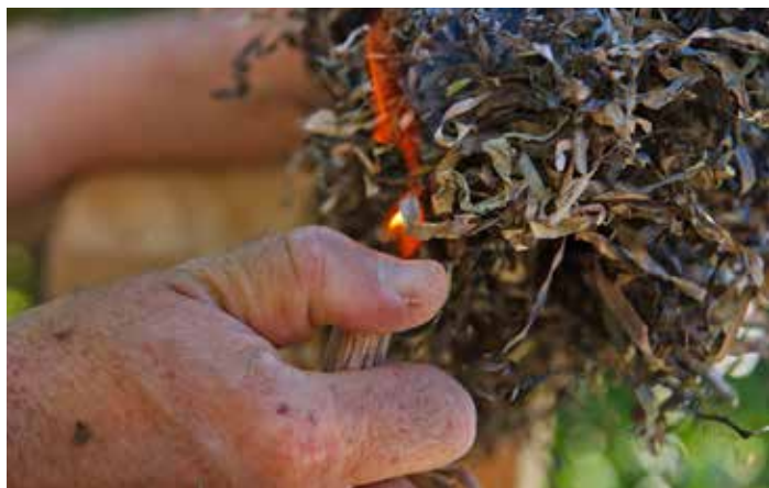
Seegras fängt nur etwas an zu glimmen, wenn man ein Feuerzeug daranhält. Die Glut erstickt sofort, wenn die Feuerquelle entfernt wird.
