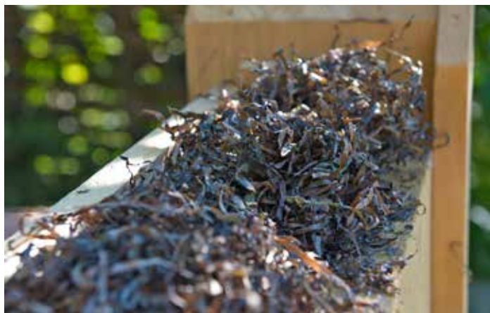
Eine 20 cm dicke Dämmschicht aus Seegras entspricht der gesetzlich vorgegebenen Wärmedämmung. Fotos: Christiane Herrmann
