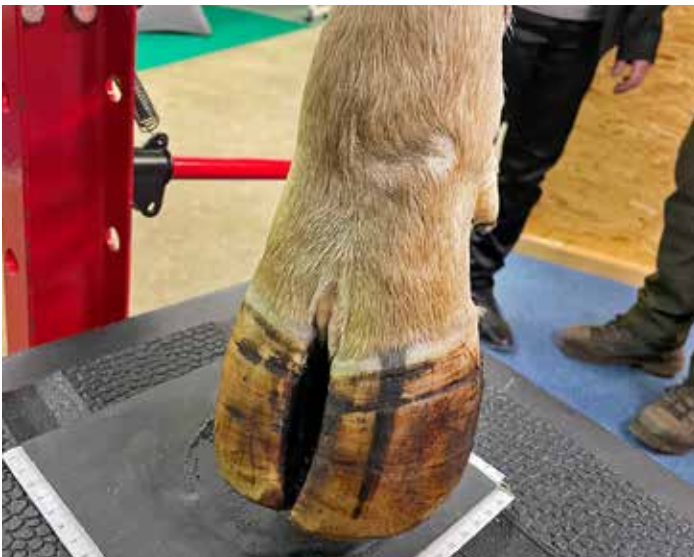
Die Messungen zur Druckverteilung zwischen Rinderklauen und verschiedenen Bodenbelägen zeigten deutliche Unterschiede in der Klauenbelastung. Foto: Isa-Maria Kuhn
