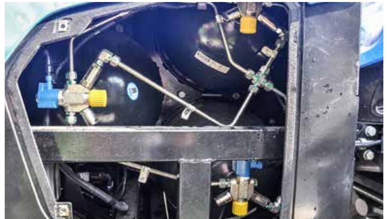
Der Front-Extender-Tank beherbergt drei je 90 l fassende Gastanks quer zur Fahrtrichtung. Zusammen mit den sieben direkt am Schlepper verbauten, 185 l fassenden Tanks ergibt sich ein Gesamtvolumen von 455 l.
