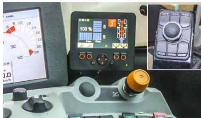
Über ein zusätzliches Bedienterminal (r.) werden die Funktionen des Bunkers gesteuert. Ein Extradisplay informiert über den Status von Förderbändern, Allradantrieb und Differenzialsperrern.
