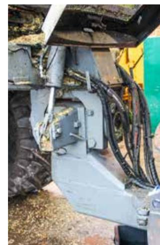
Hydraulikzylinder verspannen den Bunker gegen den Mähdrescher: Im Hang oder bei Kurvenfahrt ziehen die Zylinder den Mähdrescher hoch und leiten die Last gerade in den Rahmen ein.
