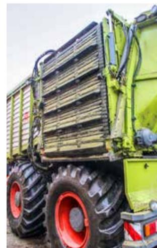
Das Überladeband stammt von einem Holmer Terra Variant und wurde durch das LU baulich angepasst.
