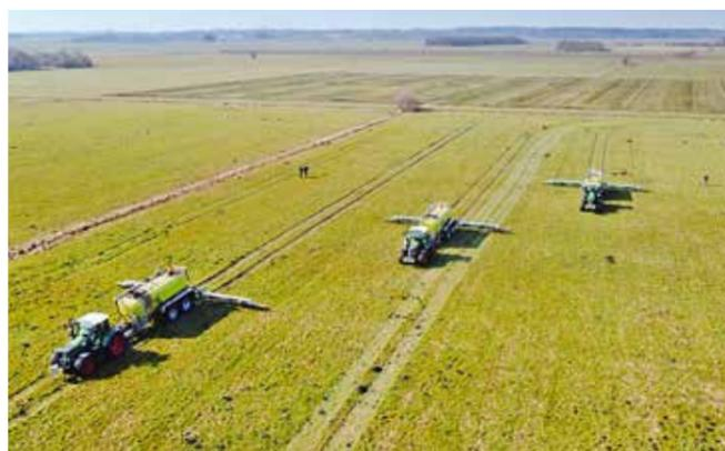
Die Gülleausbringung erfolgt bei IMP mit drei 18,5 m<sup>3</sup>-Kunststofffässern (im Bild) sowie zwei 22,5 m<sup>3</sup>-Tridem-Fässern.
