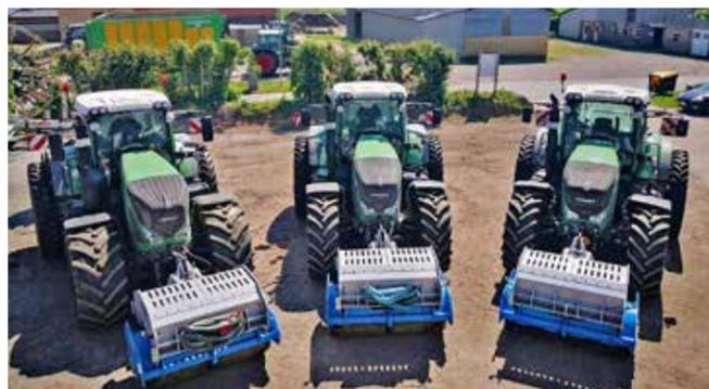
Bei IMP kommen spezielle Rüttelwalzen zum Einsatz, die eine um mindestens 10 % höhere Dichte im Silo erzeugen. Das Eindringen von Bakterien und Pilzen wird minimiert und das vorhandene Volumen besser genutzt.
