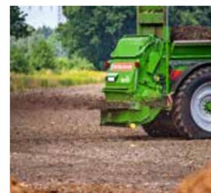
TSW 2140 E verfügbar sein. Durch die Kombination von v-förmiger Anordnung der Streuteller quer zur Fahrtrichtung und gleichzeitiger Vergrößerung des Durchmessers der Streuteller werde eine noch gleichmäßigere Verteilung des Streugutes auf die Streuteller und somit auch eine „perfekte Verteilung“ auf dem Feld ermöglicht, teilte Bergmann mit. Voraussetzung für V-Spread ist der kardani-
