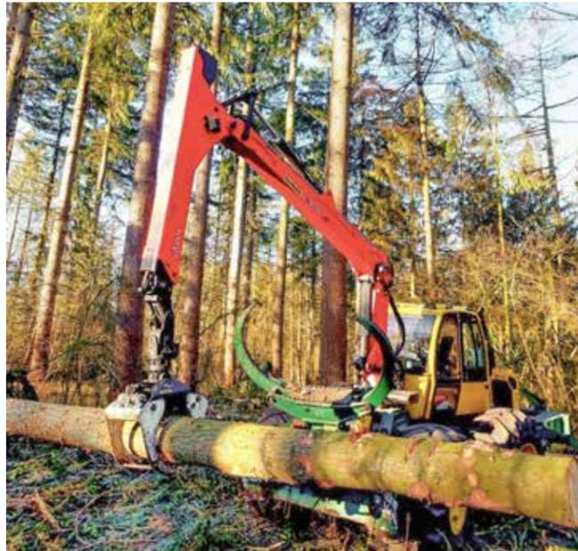
Aktuell werden die Forstspezialschlepper mit Kran und Seilwinden viel eingesetzt.
